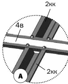
Присоединить вторую торцевую дугу. Если длина теплицы больше двух метров, присоединить нужное число вставок последовательно наращивая прогоны и силовые дуги, затем присоединить торцевую дугу.
