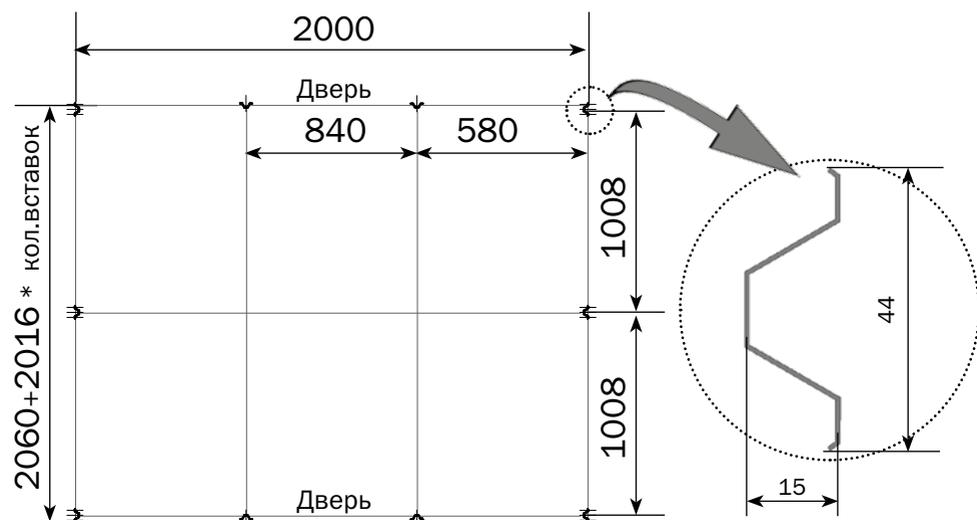
**Рис. 3** План опирания стоек теплицы на фундамент.
